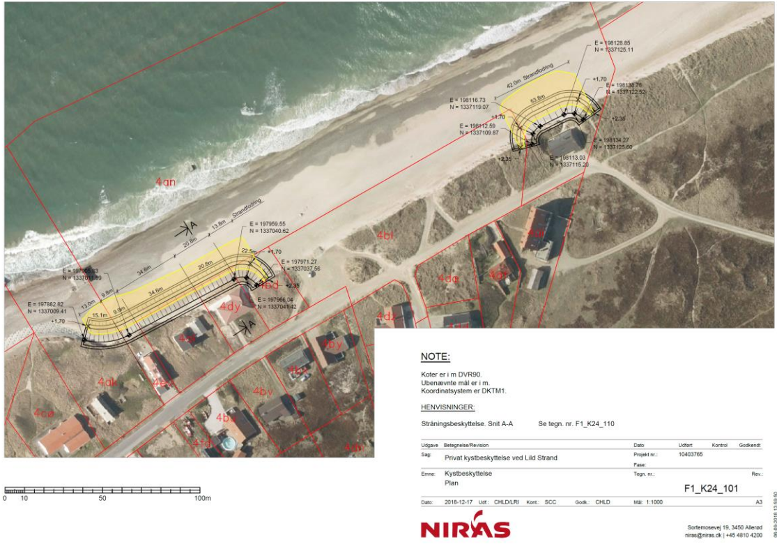
Figur 2-1 Plantegning F1 K24 101 af skråningsbeskyttelser og strandfodring, (NIRAS, Privat kystbeskyttelse ved Lild Strand - Myndighedsprojekt Ver. 1.0, 2018)
