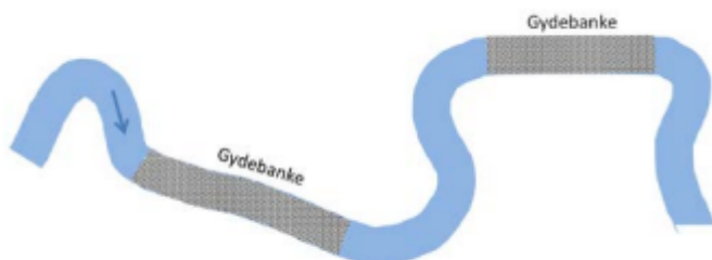
Figur 11: Placering af gydegrus imellem svingprofiler, fra vejledningen fra DTU Aqua "Sådan laver man en gydebanke for laksefisk.
