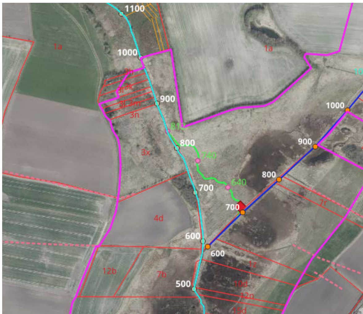
Figur 13: Genslyngning (grøn streg) af Irup Bæk (lyseblå streg), stationering ny strækning af Irup Bæk (pink cirkel og grønne tal), projektgrænse (pink streg), matrikelgrænse (rød streg), Årbæk (mørkeblå streg), sandfang (rød firkant).
