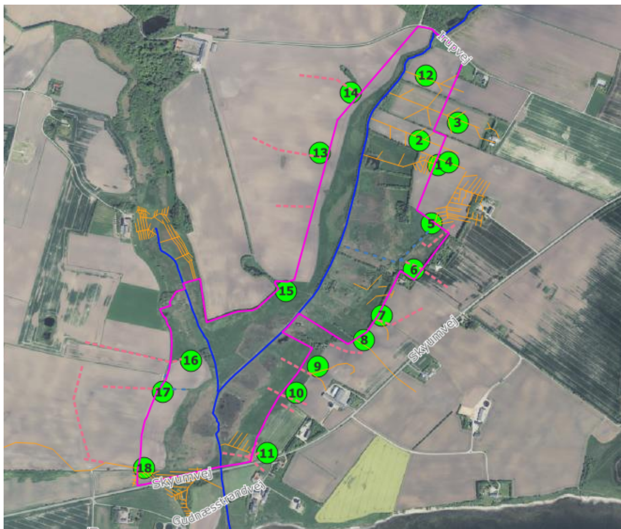
Figur 2: Oversigtskort med angivelse af kendte dræn (stiplet rød og orange) og vandløb (blå streg) i projektområdet (pink streg).
