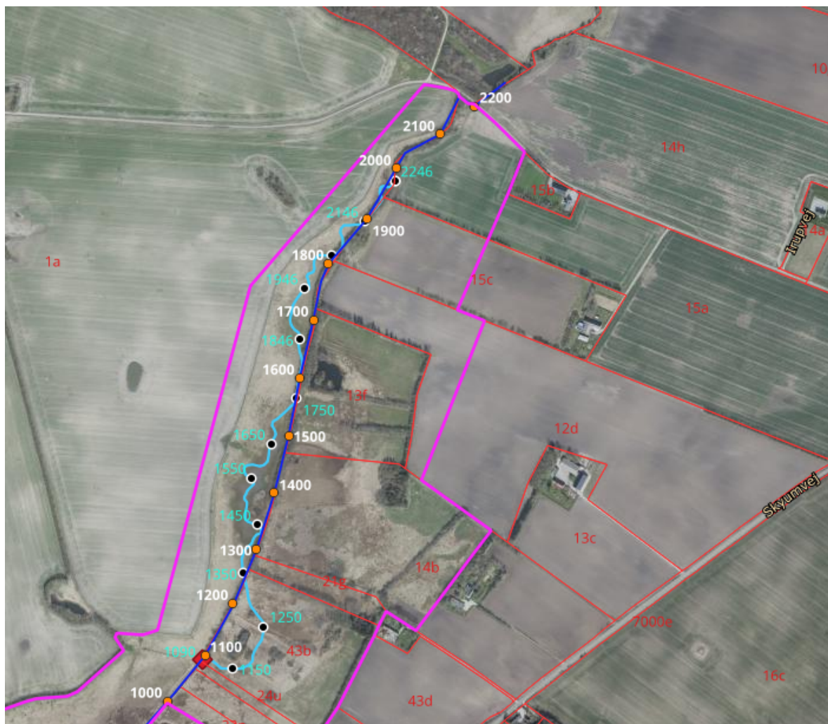
Figur 7: Forlægning (lyseblå streg) af Årbæk (mørkeblå streg) igennem projektområdet (pink streg), ny stationering i m (sorte cirkler med lyseblå tal), gl. stationering (orange cirkel med hvide tal), matrikelgrænse (rød streg).
