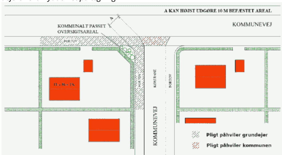
Figur 6, Pligten for ejeren af en hjørnegrund der grænser til 2 kommuneveje, hvor vejtilslutningen er udført med afvigende belægning i forlængelse af den ene vejs fortov - eller som gennemgående fortov langs denne. Pligten for selve vejtilslutningen påhviler kommunen. Den del som grundejeren skal rydde vist på tegning
